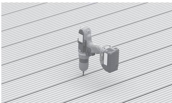
Nach 5-6 Dielen ziehen Sie die Clips mittels Schraube und mit mittlerem Drehmoment nach.
