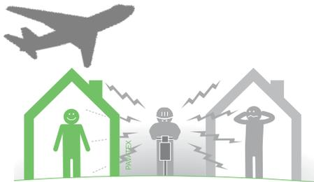
Bei einem Rohgewicht von bis zu  $240\text{kg/m}^3$  sind Holzfaserdämmstoffe die Lärmschlucker unter den Dämmstoffen. Sie sorgen dauerhaft und zuverlässig für eine erhebliche Minderung der wahrnehmbaren Geräuschkulisse, insbesondere im Bereich hoher Frequenzen.
