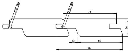
Verdeckte Schrauben bei 96 mm
