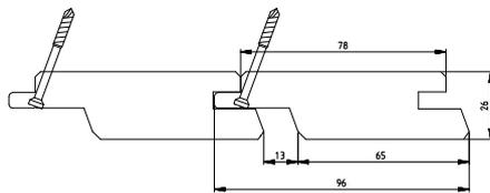
Verdeckte Schrauben bei 96 mm
