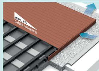
Geschlossene Fuge mit Nutleiste/Fugenprofil P5
