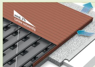
Geschlossene Fuge mit Nutleiste/Fugenprofil P5
