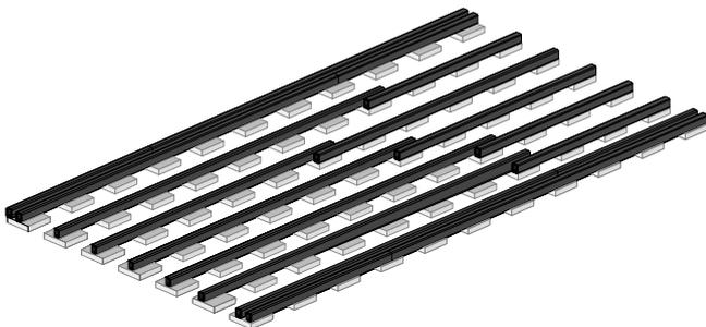
**Die äußeren Konstruktionsleisten einer Terrasse (eines Terrassenfeldes) müssen jeweils doppelt verlegt werden mit einem Achsabstand von ca. 15 cm.**
