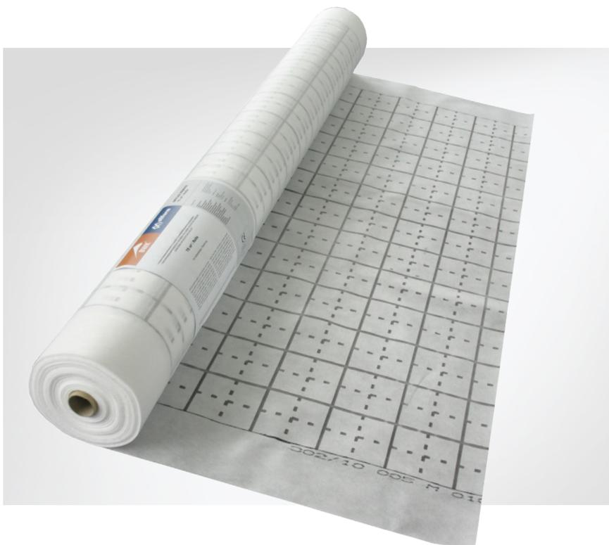
Eine Dampfbremse soll verhindern, dass feuchtwarme Luft in die Dachkonstruktion eindringen und dort als Tauwasser ausfallen kann. Bei heutigen Konstruktionen übernimmt die Dampfbremse häufig zusätzlich die Aufgaben der Luftdichtschicht.
