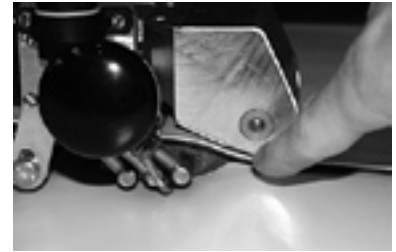
Einsatz des elektrischen Heizkeils (beim Leister Comet)
