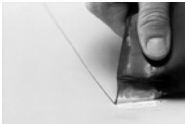
Zerstörungsfreier Schältest längs zur Naht (bei Hand- und Automatenschweißung)
